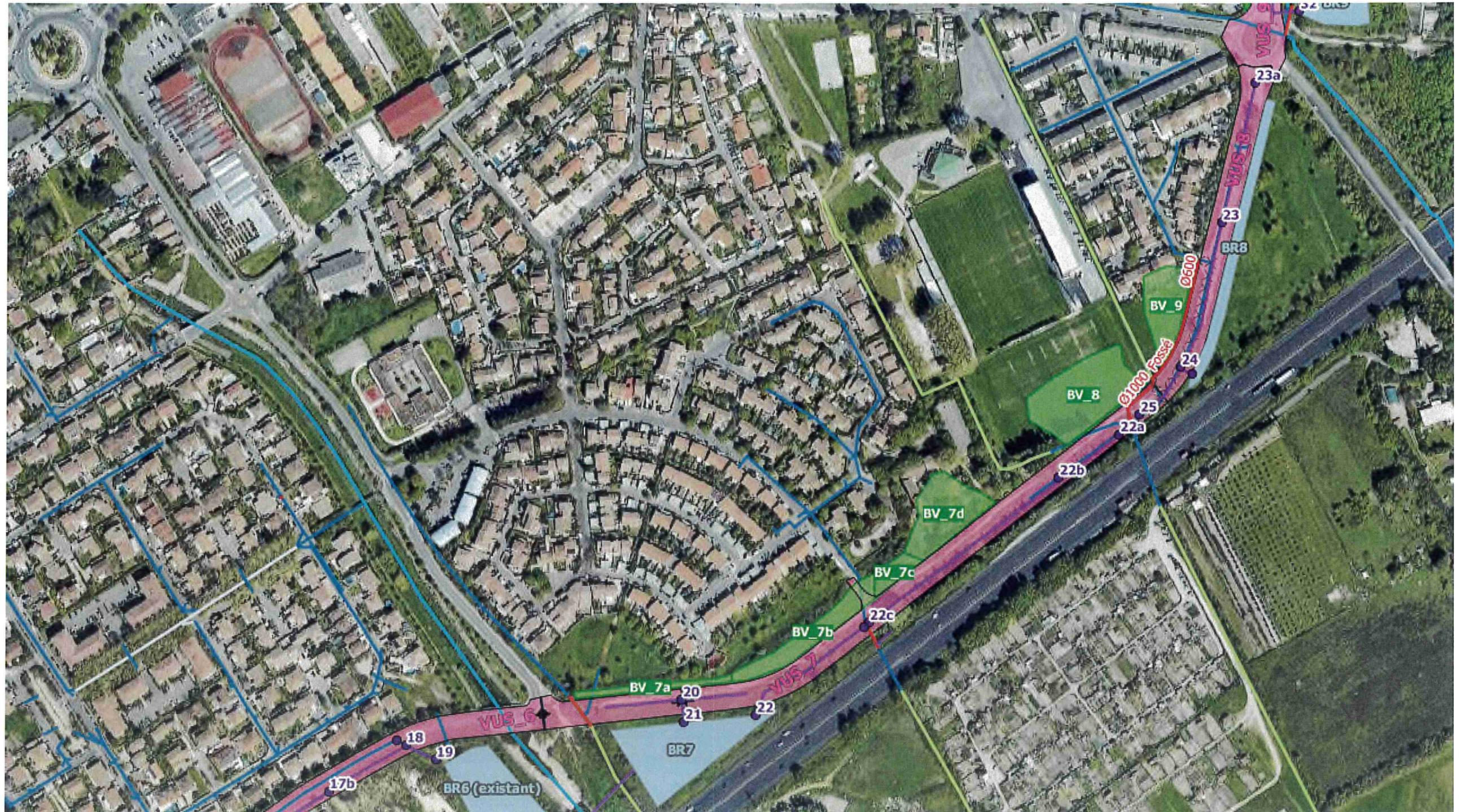
Figure 21 : Synoptique de l'assainissement pluvial projeté (2/3)
