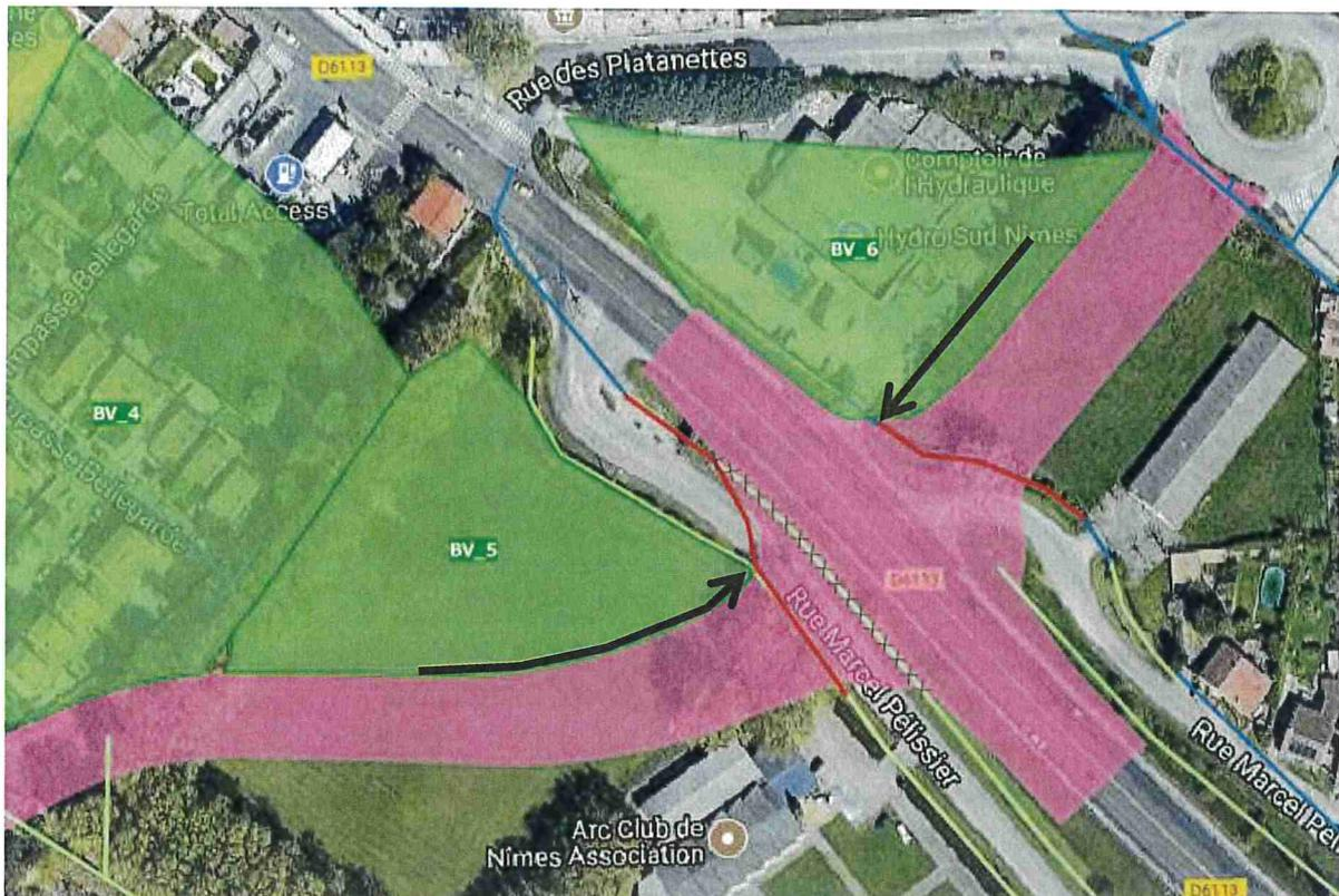
Le débit centennal estimé pour le BV6 est de 0,25 m<sup>3</sup>/s. En fonctionnement normal, le fossé bordant l'avenue ne reprend que les écoulements issus de la voie et une partie de la parcelle. Sachant qu'un Ø600 à 0,5 % de pente présente un débit capable de 0,42 m<sup>3</sup>/s, on peut s'attendre à ce que ce rétablissement soit suffisant au droit du projet sans autre contrainte.
